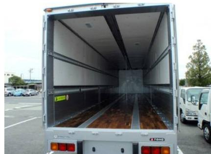
トラック架装内装材施工例
