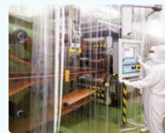
フレキシブルプリント基板用材料の製造用に世界初導入したラミネーター。技術者が量産にこぎつけた経験が、様々な素材を自在にラミネートできる技術の確立に役立つことになります。
