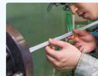
画期的なアイデアで生みだした「回転式」のダイス。光ファイバーを保護・収納できるラセン状の溝を、コンマ数ミリの精度で長さ数十キロメートルにわたり制御することができます。
