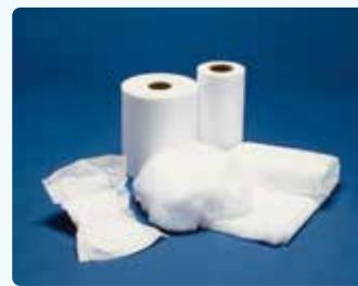
融点の異なる2種類の樹脂からなる複合型纖維「UCファイバー」を用いた熱融着型の不織布は接着剤を使用していないため、紙おむつ等の衛生材料の分野等で広く使われてきました。
