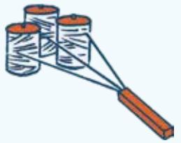
熱で固まる性質の繊維強化プラスチック（F R P）の外側に、樹脂をコーティング。その樹脂層を型に見立て後から熱処理することで、一体で成形する技術です。金型を使用せず、樹脂層を型の代わりにする当社独自のアイデアにより、引抜抵抗を小さくするとともに、生産性を大幅に向上させることに成功しました。
